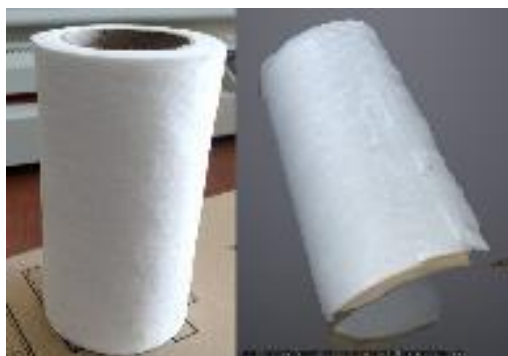
Рис. 4. Результат сканирования монотонного объекта: не получилось создать полноценную модель, так как при сканировании задней части объекта или верха сканер терял трек
