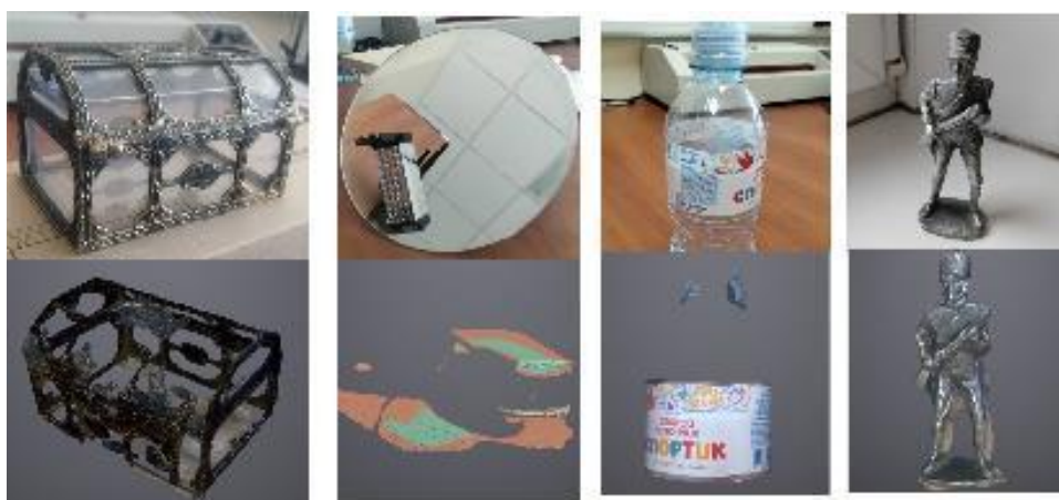
Рис. 3. Результаты работы сканера при реконструкции объектов с прозрачной или отражающей поверхностью: 3D модели искажены или же их невозможно создать
