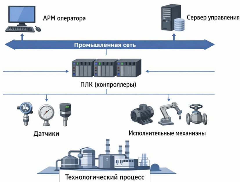
Рис. 1. Обобщенная архитектура автоматизированной системы управления технологическим процессом
