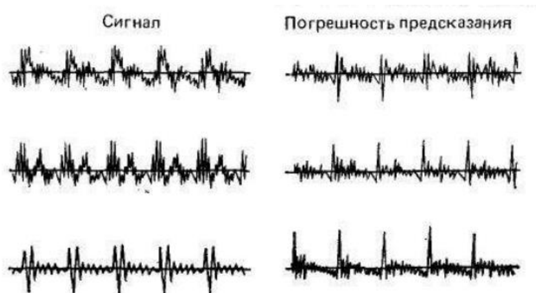
Рис. 3. Примеры сигналов и погрешностей предсказания для гласных i, e, a
