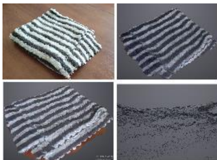
Рис. 5. Результат сканирования объекта с повторяющейся структурой: поверхность созданного облака точек вышла очень волнообразной, а текстура 3D-модели смазалась
