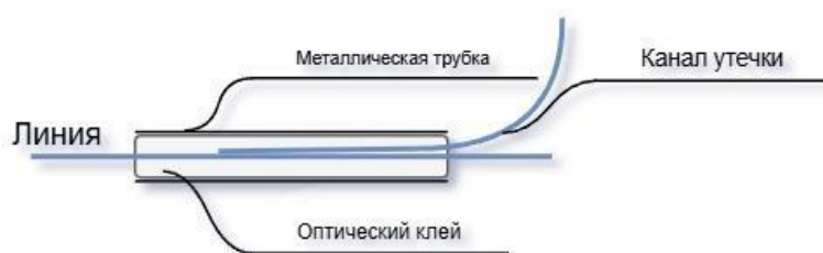
Рис. 3. Схема перехвата посредством оптического туннелирования
