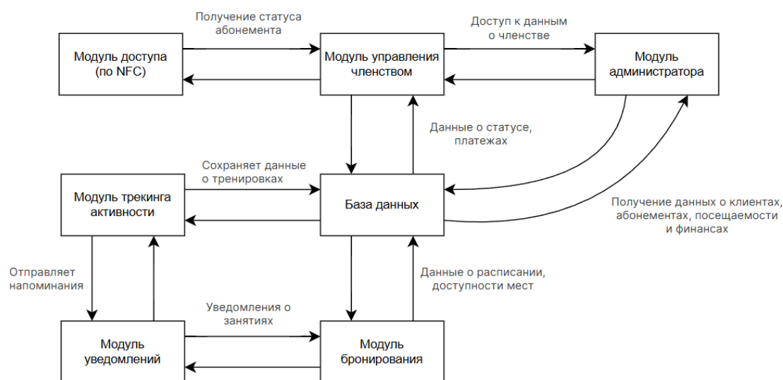
Рис. 1. Модульная схема информационной системы фитнес-клуба
