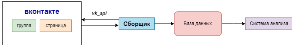
Рис. 1. Структурная схема honeypot-системы
