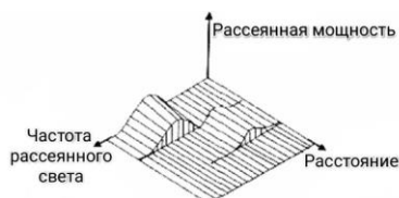
Рис. 5. Распределение спектра бриллюэновского рассеяния света в волокне
