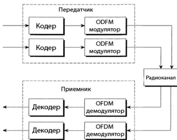
Рис. 1. Структурная схема типового комплекса радиосвязи
