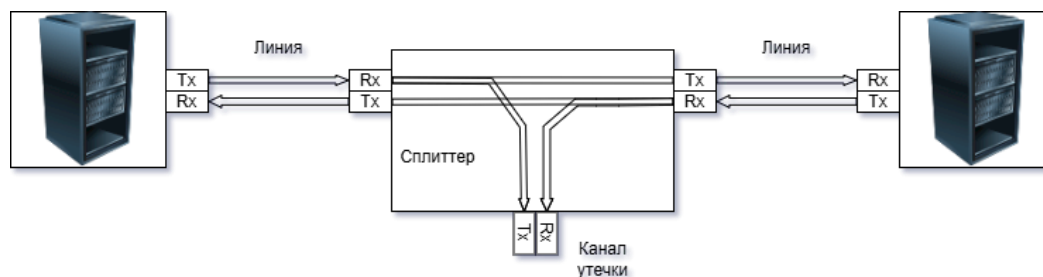
Рис. 1. Схема перехвата посредством TAP
