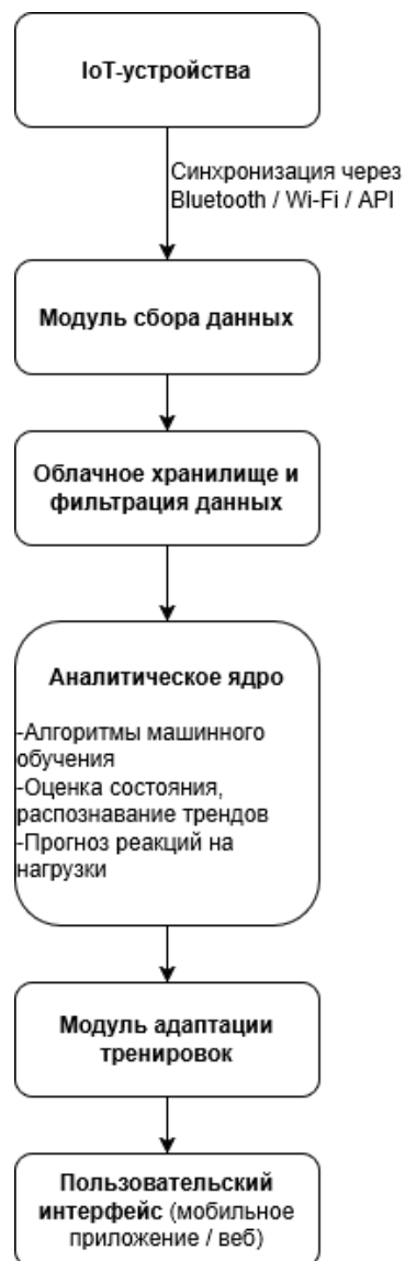
Рис. 1. Архитектура интеллектуальной фитнес-системы с интеграцией IoT-устройств
