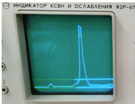
Рис. 5. S_{21} макета моста с экспериментальной топологией, линейный масштаб. Линия обведена в графическом редакторе в связи с низкой контрастностью
