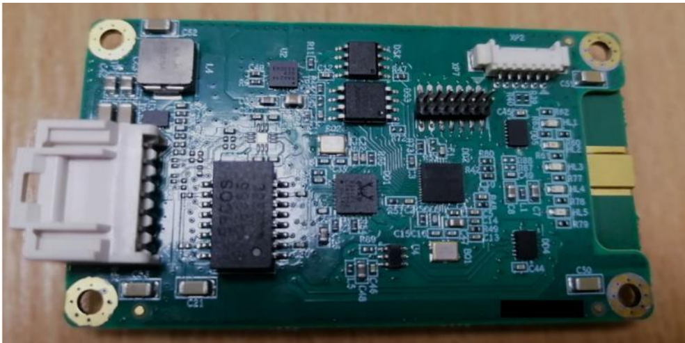
Рис. 2. Внешний вид бортового модуля командно-телеметрической радиолнии СШП-КТР
