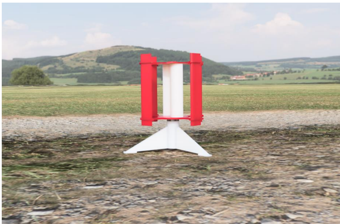
Рис.1. 3Д-модель совмещенного ротора Дарье и Савониуса
