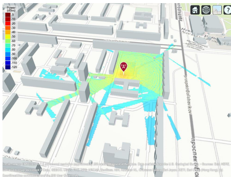
Рис. 4. Зона покрытия с учетом одиночного отражения лучей
