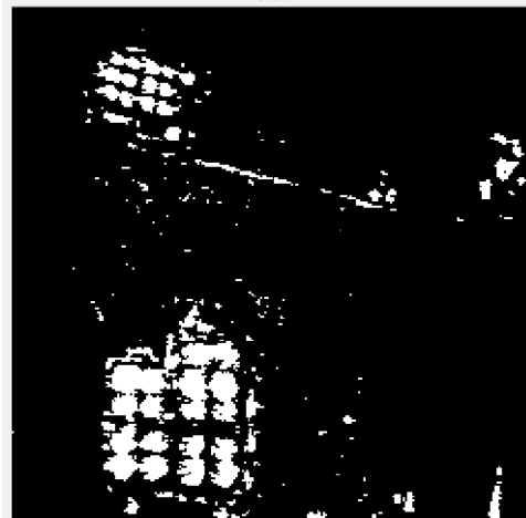
Рис. 5. Пороговая обработка бинарного изображения по методу Отсу
