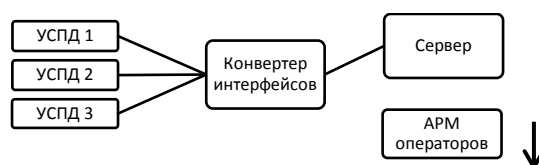
Рисунок. Простейшая схема распределенной сети автоматизированного мониторинга и контроля
