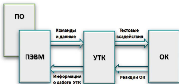
Рис. 2. Схема исследований объектов контроля при помощи комплекса УТК-512
