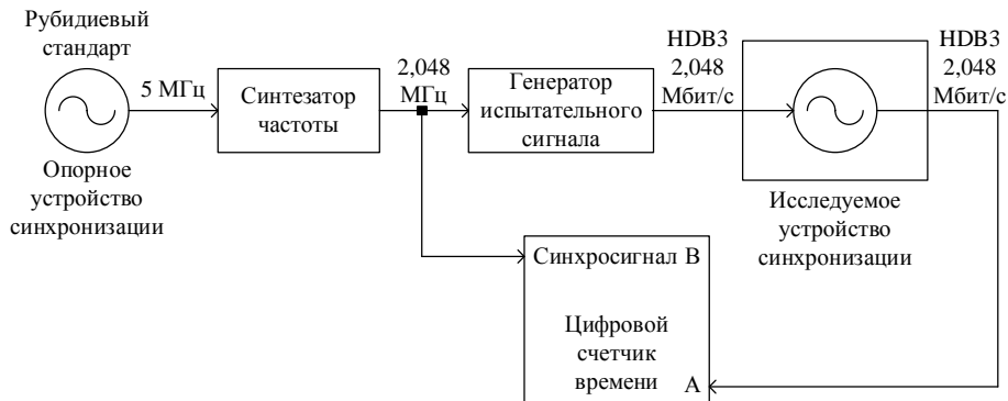
Рис. 3. Схема измерения выходного джиттера устройств синхронизации электросвязи
