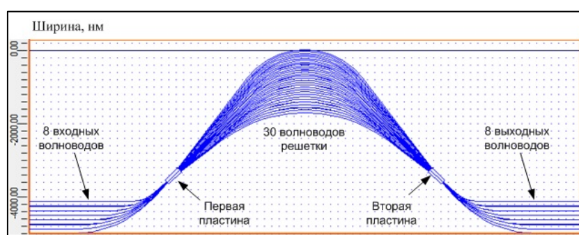
Рис. 1. Конструкция демультимплектора AWG, моделируемого в работе
