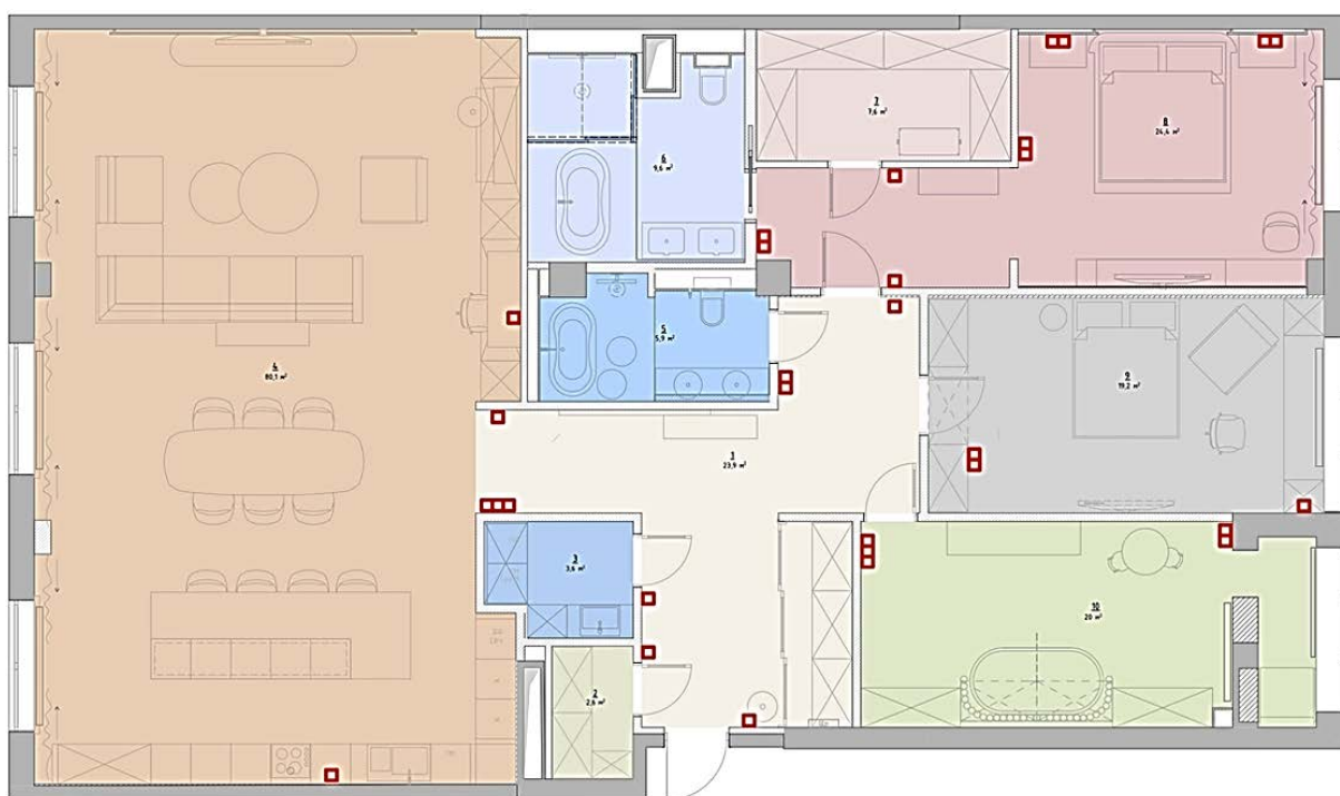
Рис. 1. Размещение Z-wave модулей в проекте
