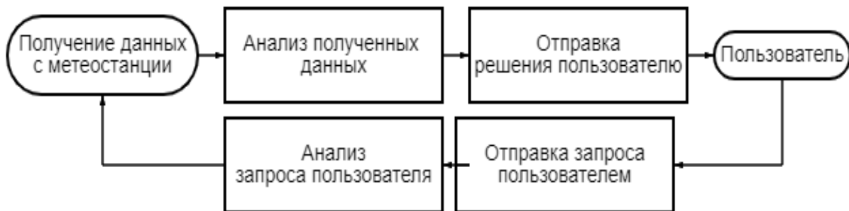
Рис. 2. Блок-схема взаимодействий пользователя и метеостанции
