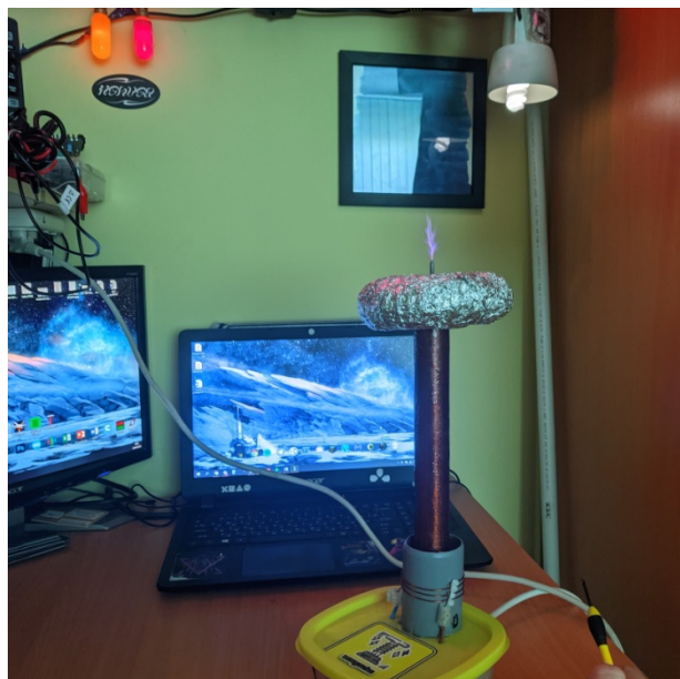
Рис. 4. Получение искрового разряда в спроектированном прототипе модернизированного трансформатора Тесла и свечение лампы под его действием
