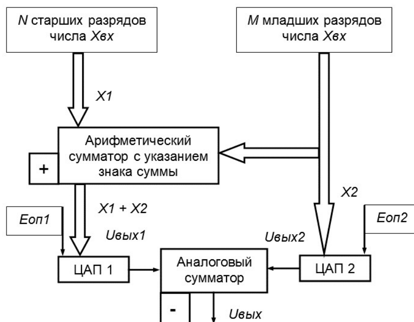
Рис. 1. Структурная схема нониусного ЦАП
