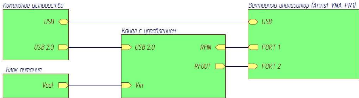
Рис. 4. Схема измерительной установки
