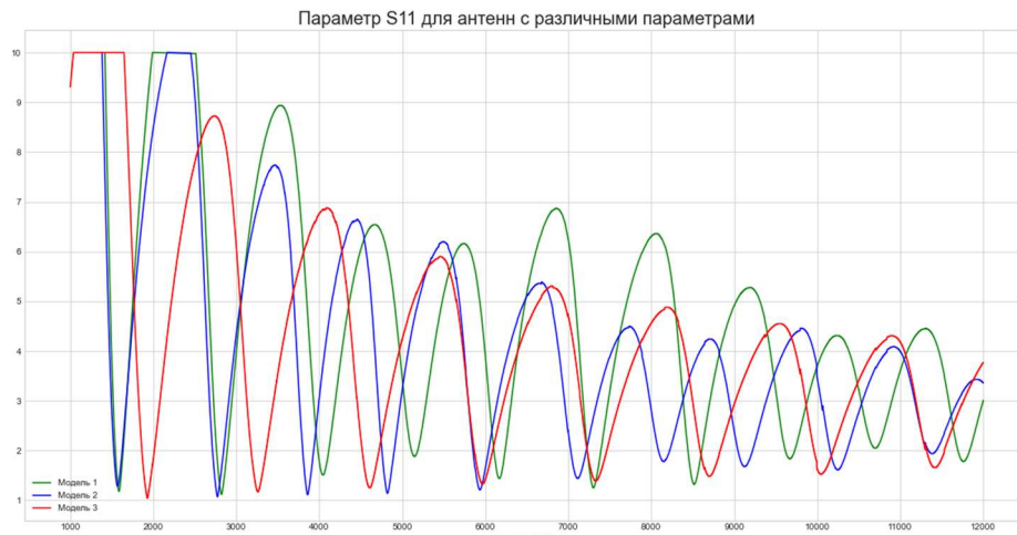
Рис. 1. Зависимость коэффициента стоячей волны от частоты для древовидных антенн с разными геометрическими параметрами
