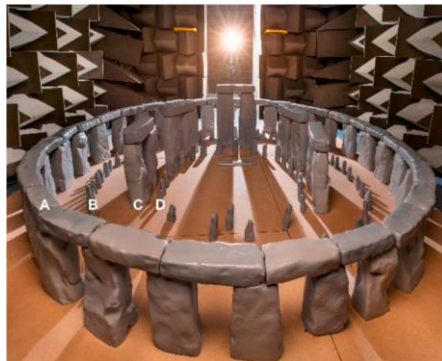
Рис.1. Уменьшенная модель Стоунхенджа в заглушенной камере [2]
