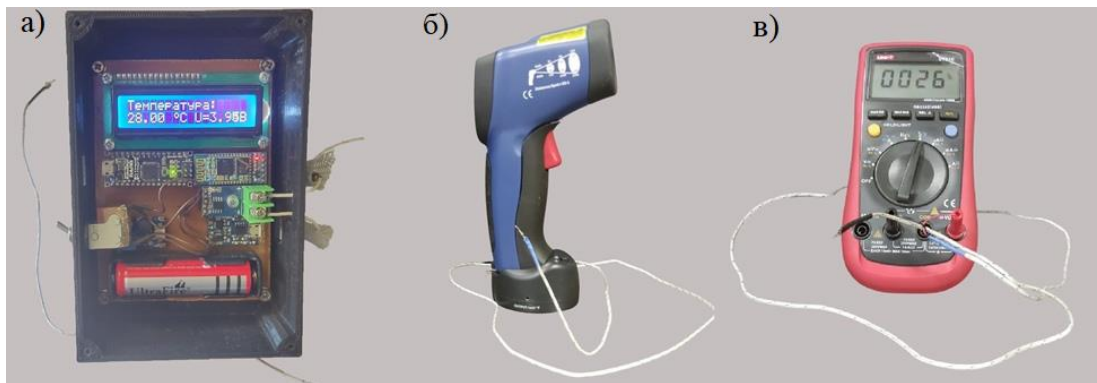
Рис. 1. Исследуемые устройства: а) Bluetooth-устройство; б) пирометр DT-8855; в) мультиметр UT61C
