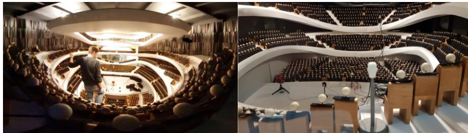
Рис. 2. Уменьшенная модель концертного зала с заполненными местами, в заглушенной камере [3]
