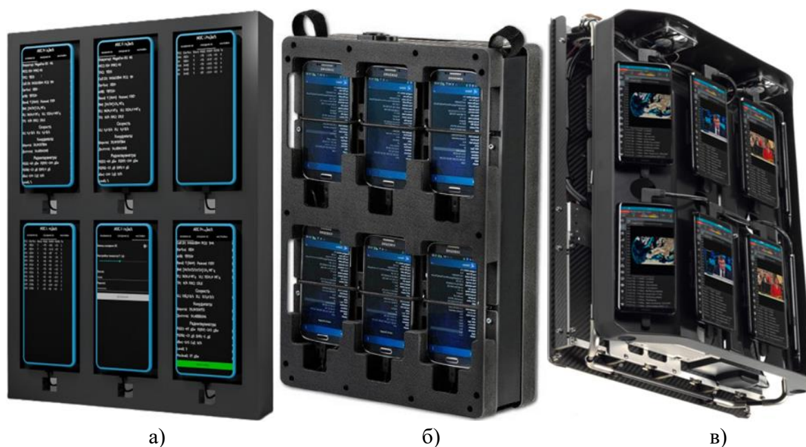
Рис. 1. Решения для проведения радиоизмерений параметров сетей мобильной связи методом обхода: а) Анализатор сетей радиосвязи (СПбГУТ, Россия) б) Nemo Walker Air (Keysight Technologies, США); в) Freerider 4 (Rohde & Schwarz, Германия)
