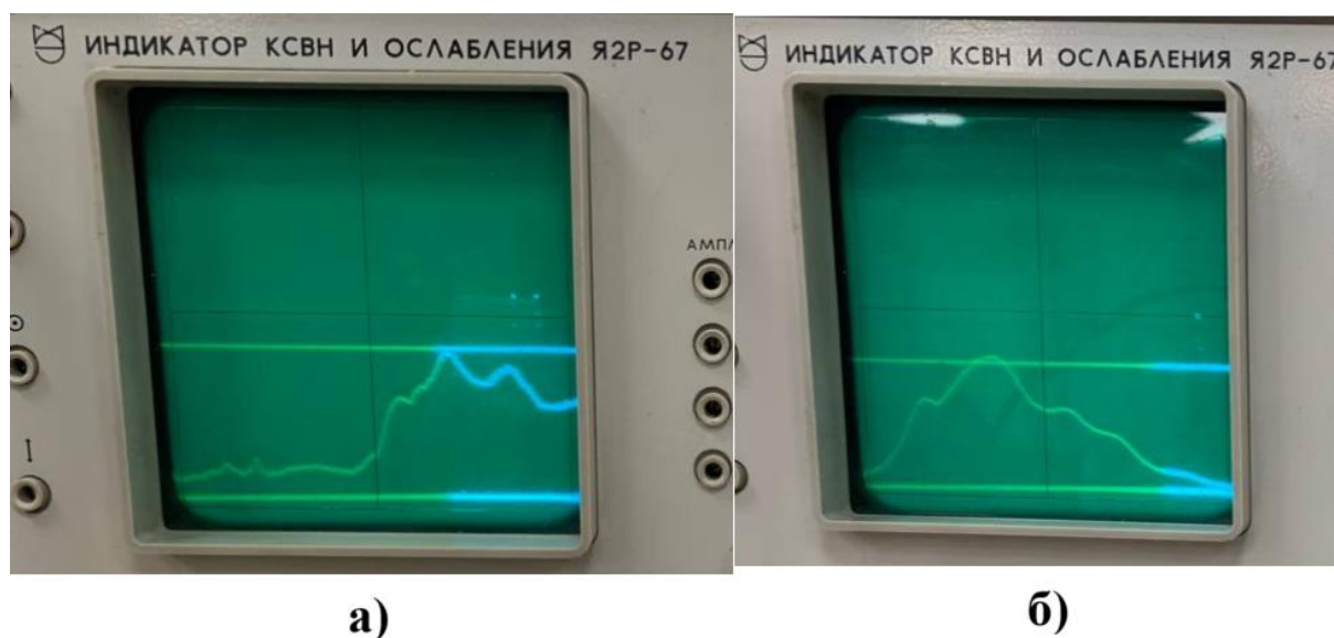
Рис. 4. Прохождение сигнала при разомкнутом (а) и замкнутом (б) контакте геркона
