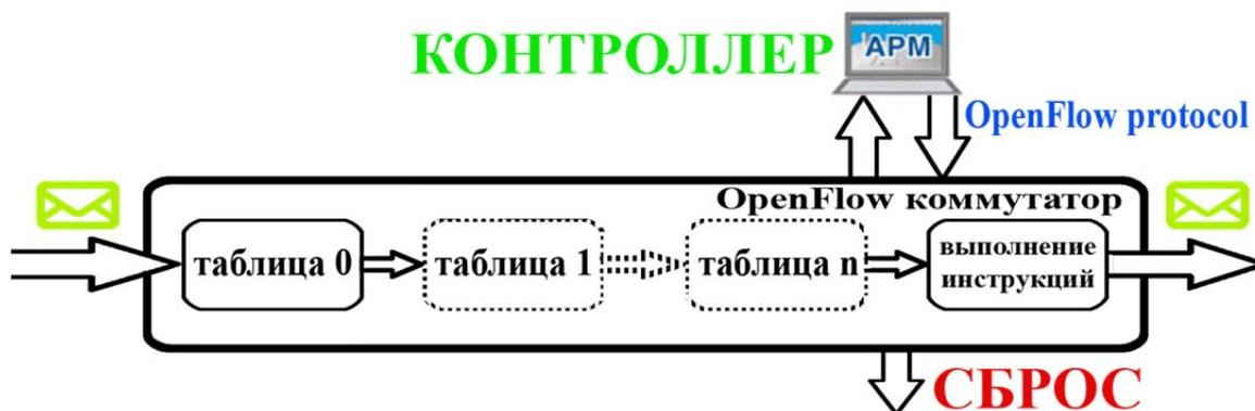
Рис. 3. Конвейер OpenFlow коммутатора
