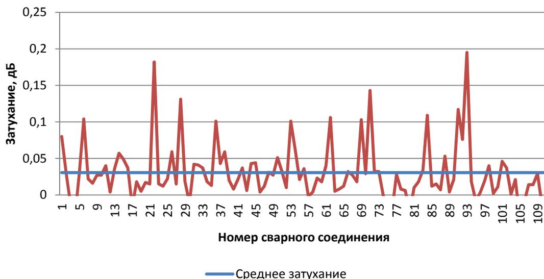
Рис. 7. Затухание на сварных соединениях
