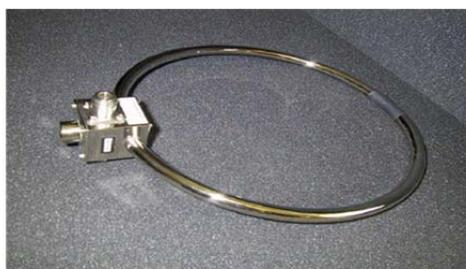
Рис. 2. Рамочная антенна
