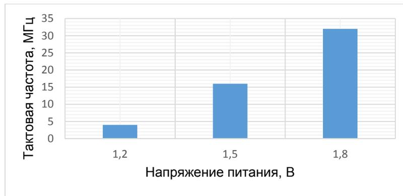
Рисунок. Технология масштабирования напряжения
