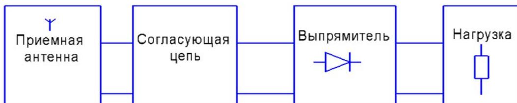
Рис. 1. Структурная схема ректенны
