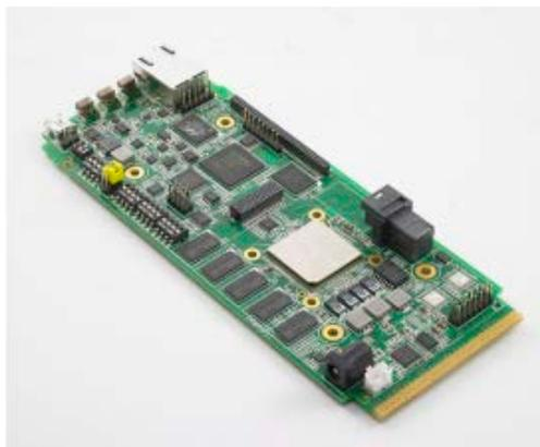
Рис. 3. Плата TMSEVM6678 с процессором C6678
