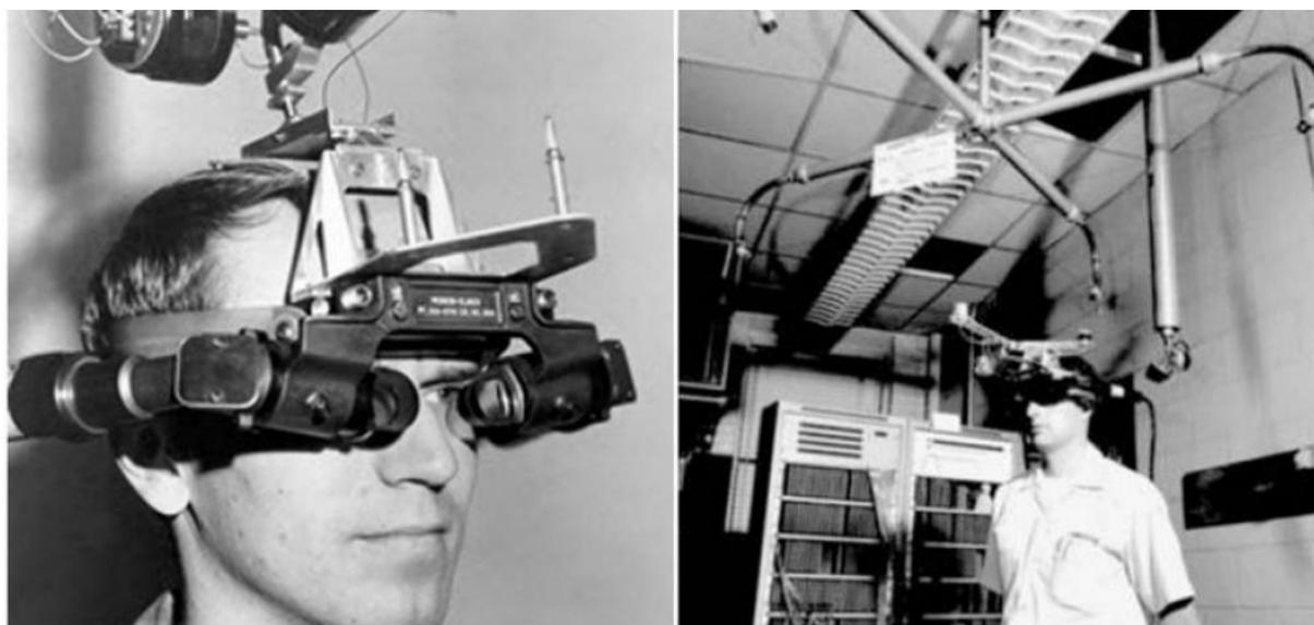
Рис. 5. Устройство виртуальной реальности «Дамоклов меч»
