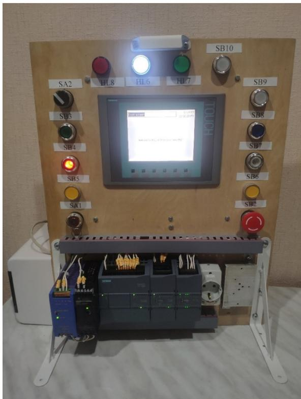
Рис. 5. Визуальное обеспечение отключения гидронасоса в ручном режиме
