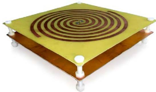
Рис. 4. Переход от линии 50 Ом к линии 135 Ом
