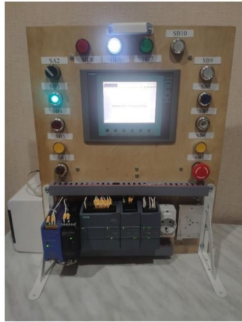
Рис. 4. Визуальное обеспечение включения гидронасоса в ручном режиме
