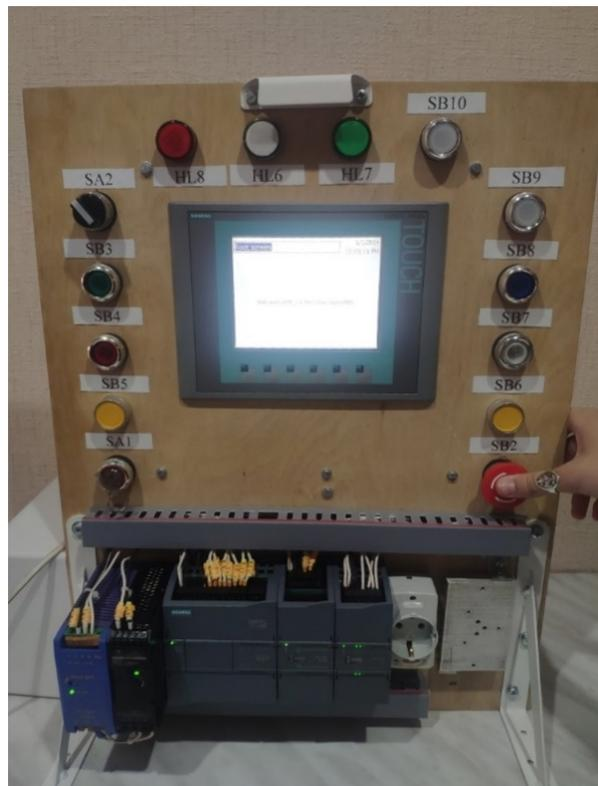
Рис. 6. Визуальное обеспечение аварийного отключения напряжения
