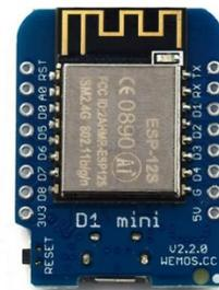
Рис. 1. Микроконтроллер lolin wemos d1 mini (esp8266)
