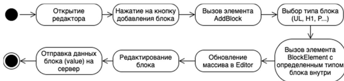
Рис. 4. Алгоритм работы элементов визуального редактора
