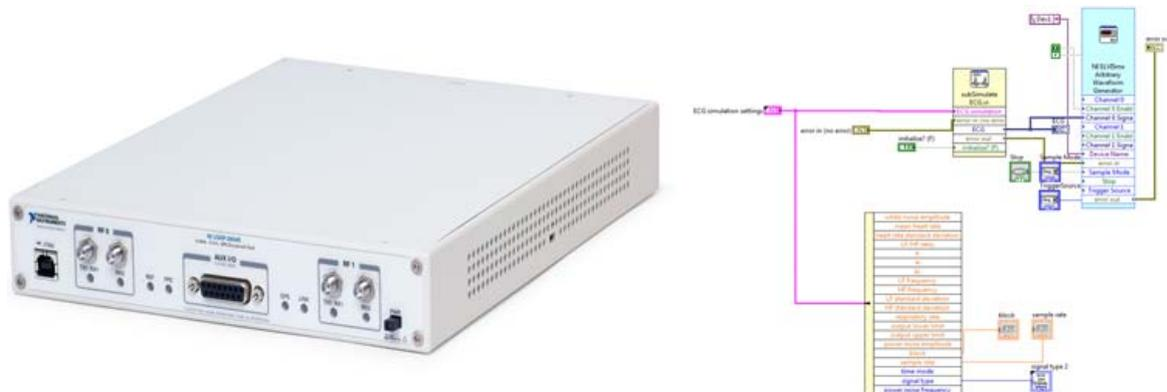
Рис. 2. USRP-2954 и пример блок-схемы LabVIEW
