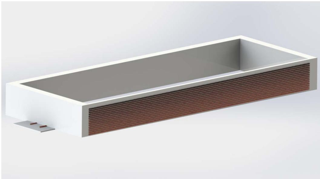
Рис. 5. Катушка индуктивности на прямоугольном каркасе
