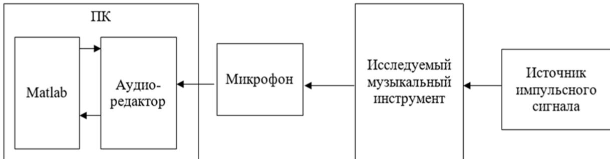
Рис. 1 Схема установки для проведения измерений
