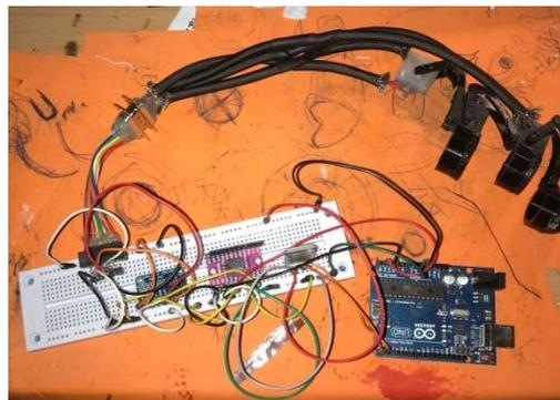
Рис. 6. Внешний вид подключения датчиков одного пальца к системе управления
