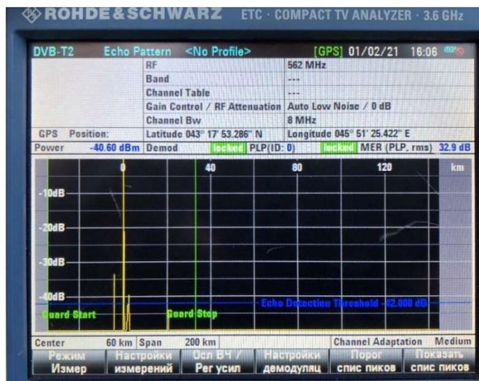
Рис. 4. Отображение эхо-сигналов на преобразователе R&S®ETC – режим «Echo Pattern»
