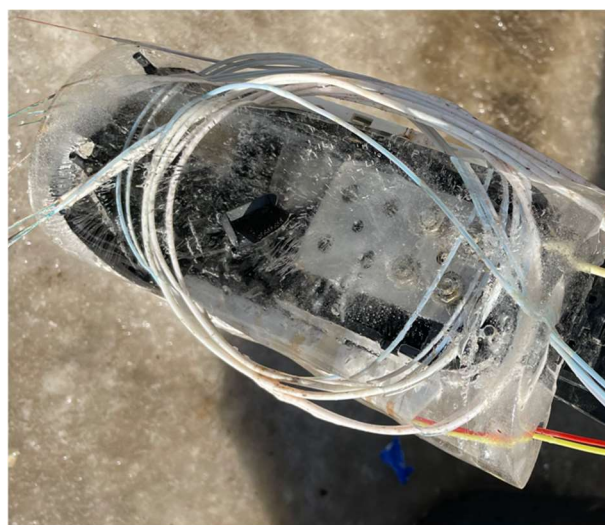
Рис. 4. Потерявшая герметичность муфта. Видна обломанная часть волокон
