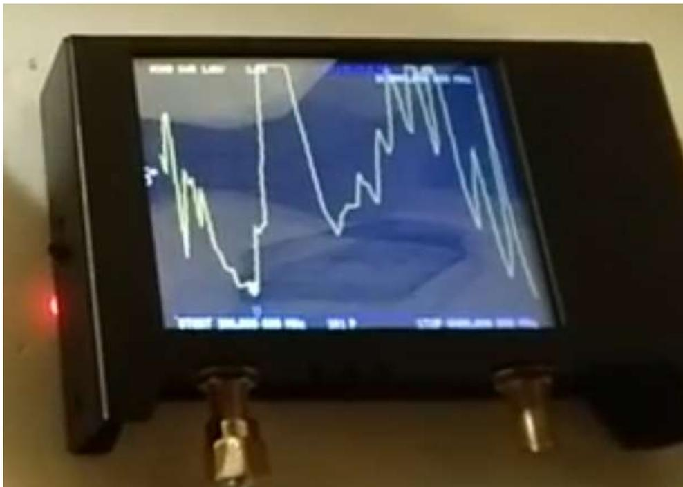
Рис. 11. КСВН третьего макета излучающего элемента с установленным диодом 3И101А без напряжения питания
