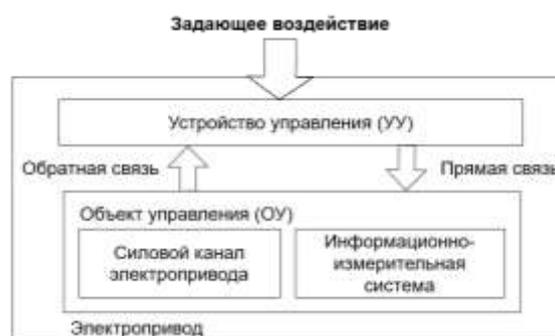
Рис. 1. Схема управления электроприводом
