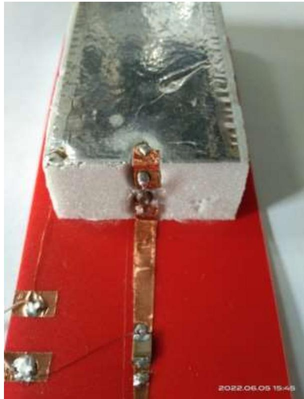
Рис. 10. Место включения туннельного диода на 3 макете
