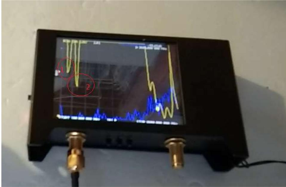
Рис. 9. КСВН второго макета излучающего элемента с установленным диодом 3И101А
