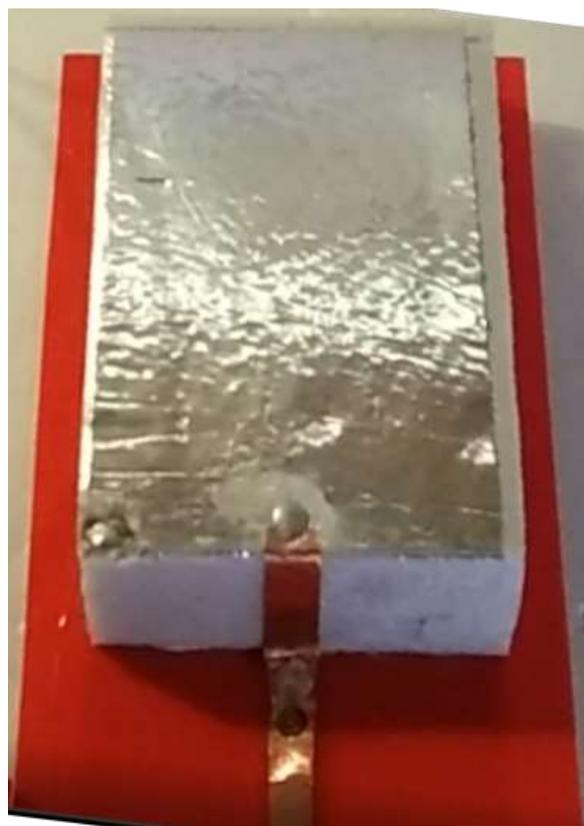
Рис. 8. Второй макет излучающего элемента с установленным диодом ЗИ101А
