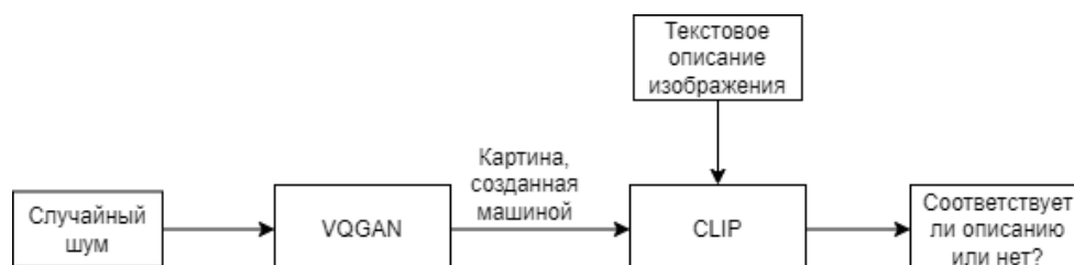
Рис. 1. Архитектура генеративно-сопоставительной сети VQGAN+CLIP
