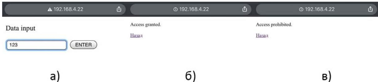
Рис. 4. Ресурс с формой ввода пароля (а). Оповещение о пропуске системой (б). Оповещение об отказе в пропуске системой (в)
