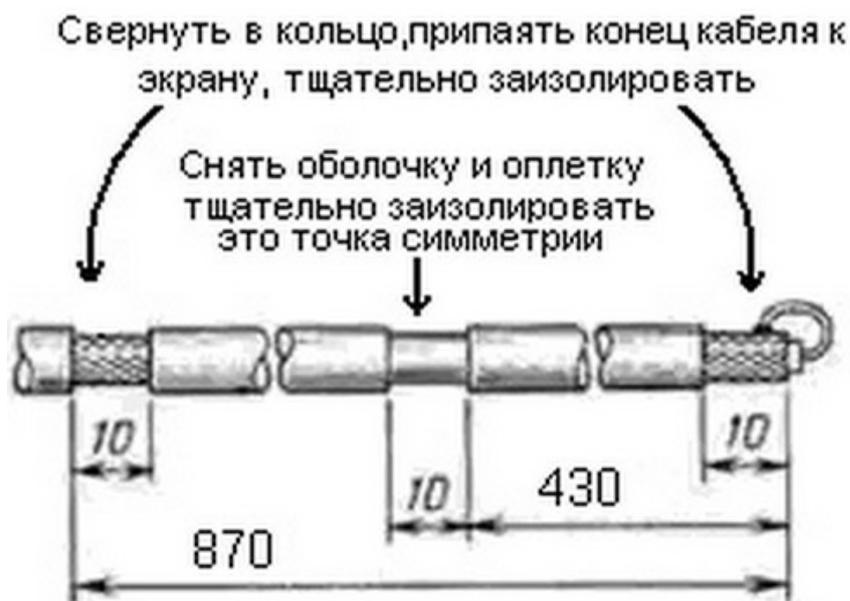
Рис. 3. Способ изготовления и размеры петли связи
